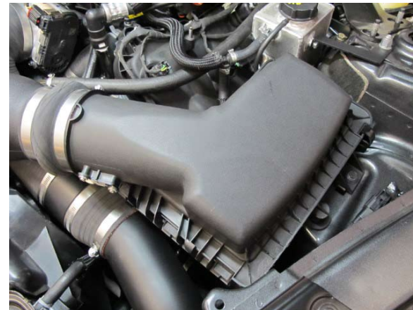
Fig. 1-e: Remove air box.
