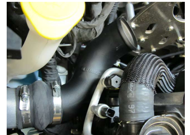
Fig. 3-b: Reinstall discharge tube A.
