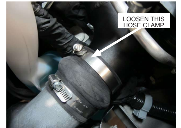
Fig. 1-m: Loosen hose clamp.
