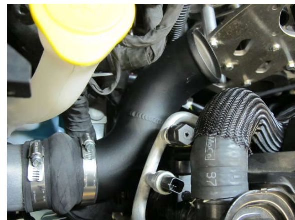
Fig. 1-r: Remove discharge tube A.
