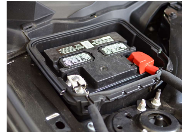
Fig. 1-a: Unplug battery cables.
